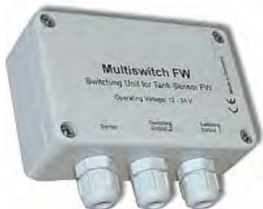
Der separate 3. Ausgang entspricht den Forderungen der NFPA / USA und ist werksseitig als Alarm-Ausgang fest auf 33% eingestellt. Er gibt bei Pegelunterschreitung ein zeitbegrenztes Alarmsignal (Dauer max. 1 Minute) aus.
